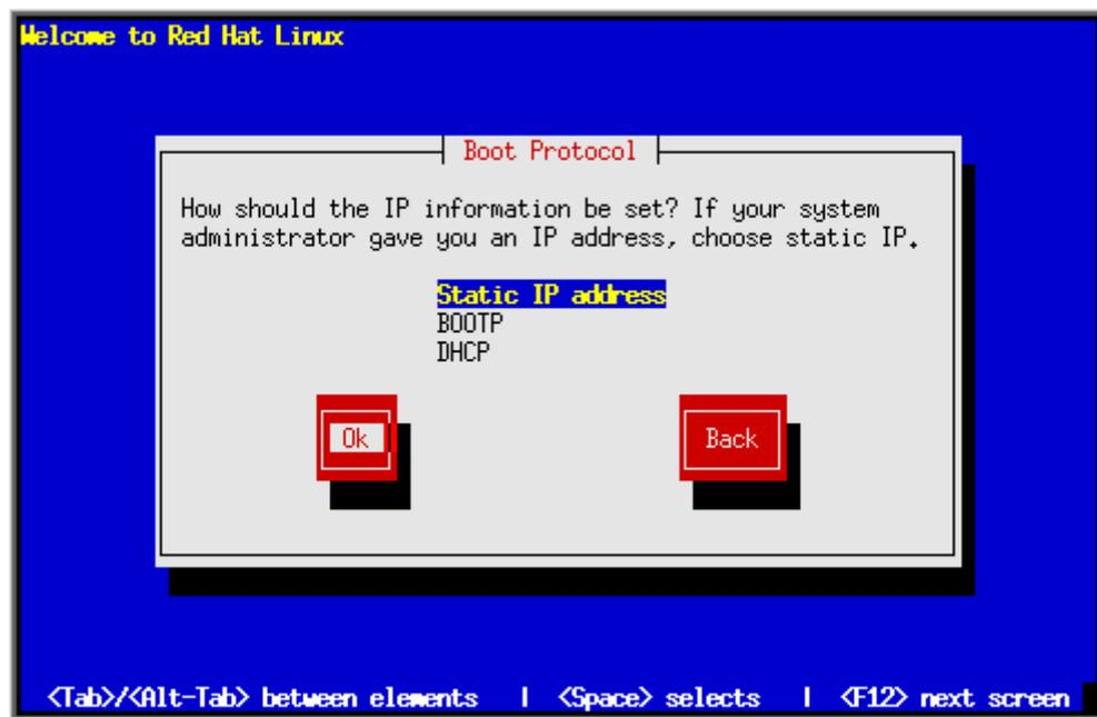
Il programma di installazione propone prima un pannello con l'elenco delle schede di rete individuate e quindi richiede il tipo di configurazione desiderata. Ci porremo nel caso della configurazione di un IP statico, piuttosto comune per un server di rete.
