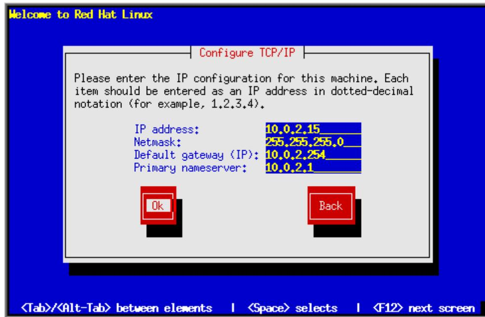
Le informazioni richieste permettono di assegnare l'indirizzo IP e il netmask alla Network Interface. Viene inoltre richiesto l'indirizzo del default gateway da inserire nella routing table.
